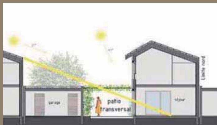
Une implantation et un dessin du bâti qui captent les rayons du soleil en été et s'en protègent en hiver.
