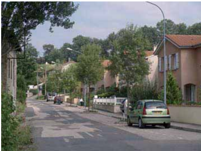
Trottoir et stationnement longitudinal (ponctué de plantations) offrent un traitement simple et assurent une transition avec la rue pour la sécurité et la tranquillité des riverains.
