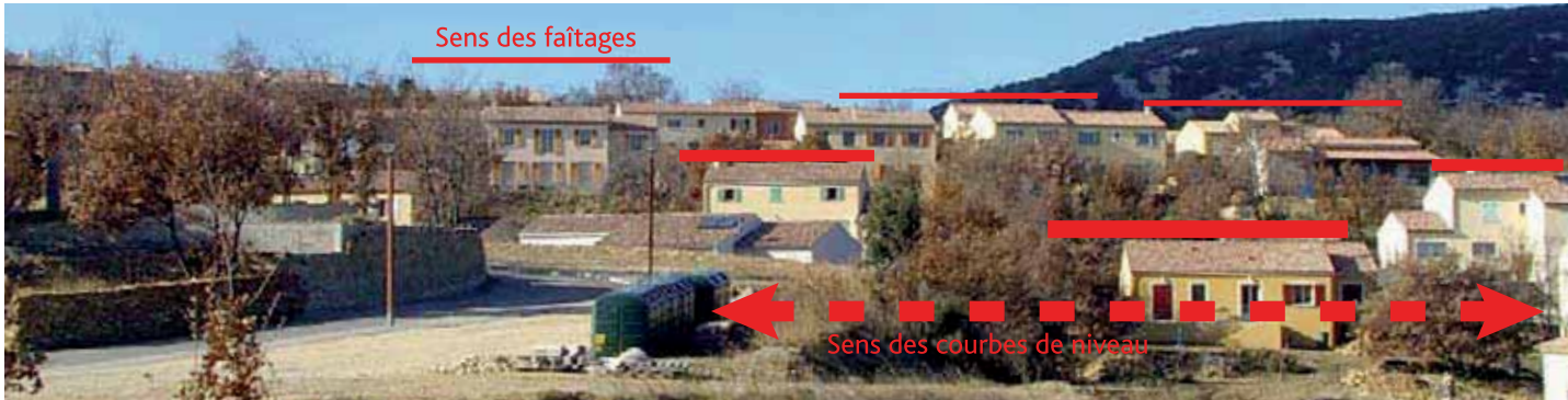
Une implantation du bâti en terrasses parallèlement aux courbes de niveau pour révéler le relief.
